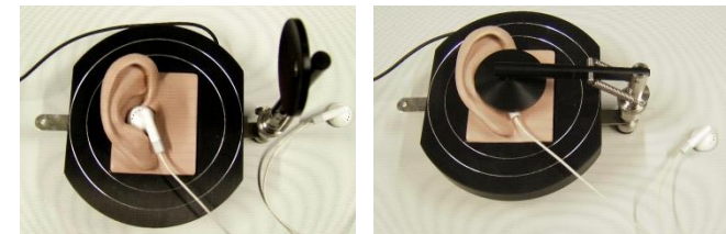
Messung eines Kopfhörerlautsprechers mit künstlichem Ohr
