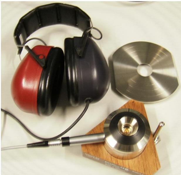
Audiometriekopfhörer mit Ohrkuppler und Mikrofon zur Kalibrierung
