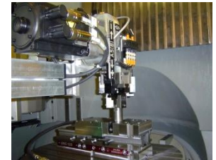
Bauteilübergabe an CNC - Fräsmaschine
