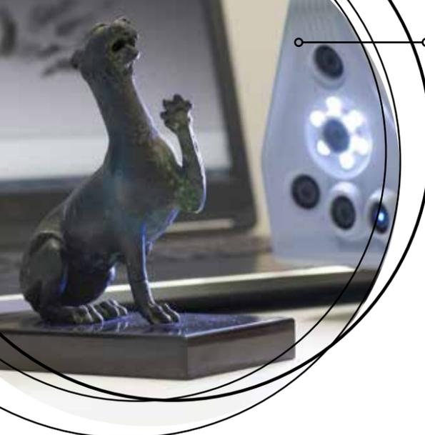
Laboringenieur Gerd Brändlein während des Digitalisierens der antiken Statuette mit dem Artec Spider® Scanner.
